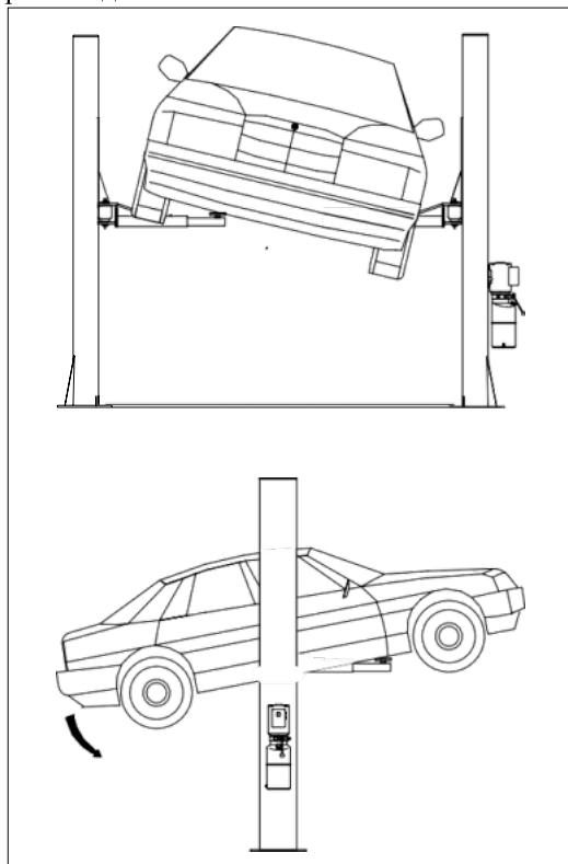
Рис 11 Опасность падения автомобиля.
