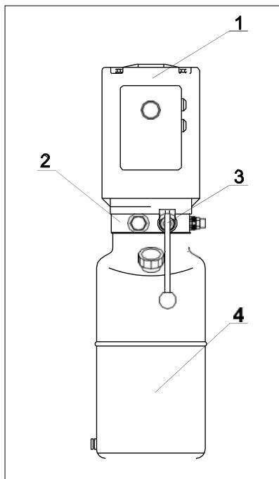
*Рис. 3 Гидравлический силовой блок*
