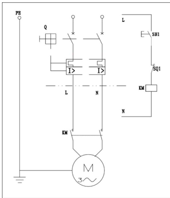
Рис. 5 Однофазное электропитание
