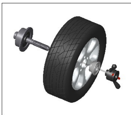
Вал - колесо— подходящий конус (вершиной внутрь)— быстросъемная гайка
